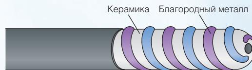
Два электрода: Дизайн выполнен в форме спирали
